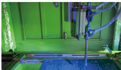
PCBA喷涂后蓝光检测
